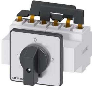
SENTRON, выключатель-разъединитель 3LD, переключатель, 3-пол., Iu: 32 A, рабочая мощность/ при AC-23A при 400 В: 11,5 кВт, фронтальное крепление, привод с поворотной рукояткой, цвет: черный, 4-винтовое крепление рукоятки
