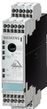
Модуль заземления AS-i IP20 S22,5, Контроль замыкания на землю 1 вход, удаленный сброс 2 x сигнальный контакт, Реле DC-12 1 A/DC-13 500 мА (24 В) Пружинная клемма Установочная ширина 22,5 мм адрес AS-i не требуется только контроль AS-интерфейса
