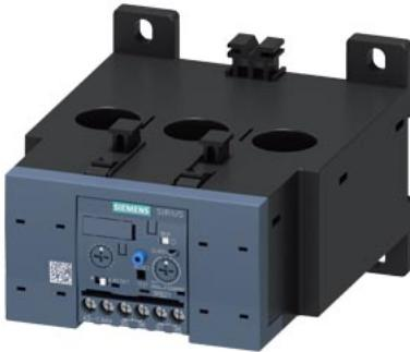
Реле перегрузки 50–200 А для защиты двигателя Типоразмер S6, класс 5–30E Для установки на контакторах/автономной установки Главная цепь: шинный трансформатор тока. Вспомогательная цепь: винтовое соед. Ручной/автоматический сброс Внутреннее обнаружение замыкания на землю
