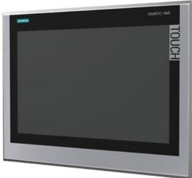
SIMATIC HMI, панель оператора TP1500 Comfort Inox с лицевой поверхностью из нержавеющей стали, защитная мембрана дисплея, степень защиты лицевой поверхности IP66K, широкоформатный TFT-дисплей с диагональю 15 дюймов, интерфейс Profinet, интерфейс MPI/PROFIBUS DP, 24 МБ пользовательской памяти, Windows CE 2013, настройка в среде WinCC Comfort
