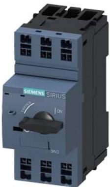
Специальный тип Автоматический выключатель, типоразмер S00 для пусковой сборки Номинальный ток 16 A N-расцепитель 208 A Подключение на пружинных клеммах Стандартная коммутационная способность Температура окружающего воздуха –50 °C 500 рабочих циклов
