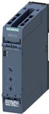
Реле времени, многофункциональное. 2 переключающих контакта, 13 функций принудительного ведомого релейного контакта 24–240 В AC/DC AC, 50/60 Гц 7 диапазонов времени (0,05 с – 100 ч) со светодиодом Пружинная клемма (Push-In)
