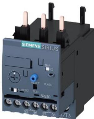
Реле перегрузки 1–4 А электронн. для защиты двигателя Типоразмер S0, класс 1 НЗ Для установки на контакторах Главная цепь: винт Вспомогательная цепь: винт Ручной/автоматический сброс
