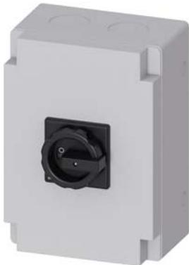
SENTRON, выключатель-разъединитель 3LD, главный выключатель, 3-пол., Iu: 125 A, рабочая мощность/ при AC-23A при 400 В: 45 кВт, герметизированный диэлектрический корпус для метрического резьбового крепления, 1 Н3, 1 НО, поворотный привод, цвет: чёрный
