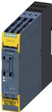
Предохранительное устройство SIRIUS Базовое устройство серии 3SK2 10 F-DI, 2 Оу-ЦВых, 1 ЦВых, 24 В DC параметрируется с помощью SIRIUS Safety ES Установочная ширина 22,5 мм Винтовой зажим до SILCL 3 (DIN EN 62061) до уровня производительности Е (ISO 13849-1) Расширения вывода 3SK1 и помехоустойчивые пускатели электродвигателя 3RM1 через модульный соединитель с возможностью подключения
