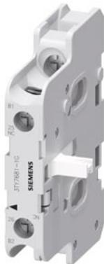
Блок дополнительных контактов, для переключения катушки в цепи постоянного тока с экономичным потреблением с винтовым зажимом для 3TF57–3TF69
