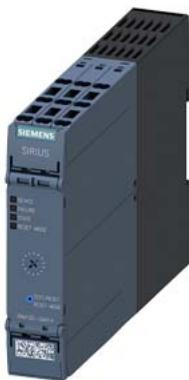
Реверсивный пускатель, 3RM1, 500 В, 0,09–0,75 кВт, 0,4–2 А, 110–230 В AC, подключение на пружинных клеммах
