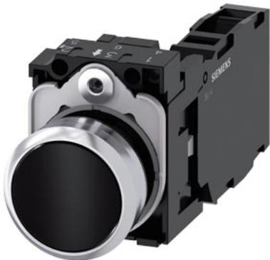
Кнопочный выключатель, 22 мм, кругл., металл, глянцев., цвет: черный, кнопка, плоск., нажатием на кнопку, с держателем, 1 НО + 1 НЗ, винтовой зажим
