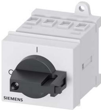
SENTRON, выключатель-разъединитель 3LD, главный выключатель, 3-пол., Iu: 16 A, рабочая мощность/ при AC-23A, при 400 В: 7,5 кВт, для установки в распред. щиты, привод с поворотной рукояткой, цвет: черный, рукоятка непосредственно на выключателе
