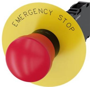
Грибовидная кнопка аварийного останова, 22 мм, кругл., пластмасса, цвет: красный, 40 мм, положительная блокировка, согласно DIN EN ISO 13850, разблокировка вытягиванием, с желтой табличкой, Надпись: Emergency stop, с держателем, 1 HO + 1 NO, винтовой зажим
