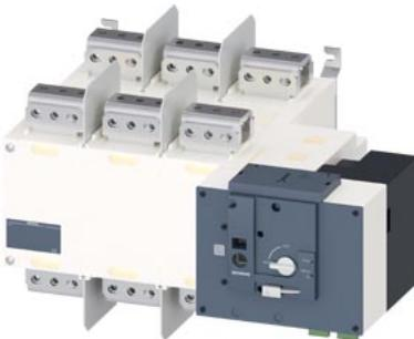
SENTRON, сетевой коммутатор ЗКС, с дистанционным управлением, RTSE, 3-пол., Iu: 3200 A, Ue AC: 415 В, le при AC-33В, при 415 В: 1250 А, винтовое крепление, моторизованный привод, правосторонний, длинная поворотная рукоятка, шинное соединение
