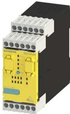
SIRIUS, Центральный модуль 3RK3 ASIsafe Basic для модульной системы безопасности 3RK3 1/2 Оу-ЦВх, 6 ЦВх, 1 Оу-РелВых, 1 Оу-ЦВых, 24 В DC Мониторы ведомых устройств ASI Активация 8 безопасных выходов на разъеме шины AS-интерфейса возможность параметрирования с помощью программного обеспечения Safety ES Установочная ширина 45 мм Винтовые зажимы до SIL3 (МЭК 61508) до уровня производительности Е (ISO 13849-1) без блока расширения с возможностью подключения
