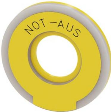
Шайба, круглая, для грибовидной кнопки аварийного останова, цвет: желтый, с подсветкой, толщина 5 мм, наружный диаметр 60 мм, внутренний диаметр 23 мм, с надписью: Not-aus
