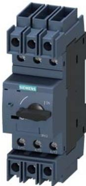
Автоматический выключатель, типоразмер S00 для защиты трансформатора с аprobацией размыкателя цепи UL 489, CSA C22.2 № 5-02 Максимальный расцепитель тока с обратнозависимой выдержкой времени 4 A N-расцепитель 82 A Винтовой зажим Стандартная коммутационная способность
