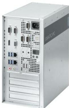
SIMATIC IPC, промышленный ПК IPC527G (Box PC); Core i5-6500 (4C/4T, 3,2 (3,6) GHz); 256 GB SSD, встроенный; 8 GB DDR4; Windows 7 Ultimate 64-bit, MUI; 2x Gigabit Ethernet (IE/PN); 1x DisplayPort, 1x VGA; 4x USB 3.0, 2x USB 2.0; 2x RS232/485/422 (можно выбирать); 2x RS232, 1x 8
