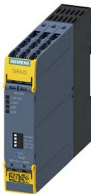
Предохранительное устройство SIRIUS Базовое устройство серии Advanced Размыкающие цепи реле 3 замыкающих контакта плюс сигнальная цепь реле, 1 размыкающий контакт  $U_s = 24$  В DC Винтовой зажим
