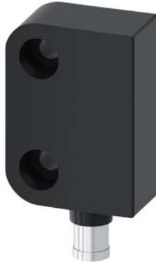
Выключатель с магнитным приводом Контактный блок, прямоугольный малый 26 x 36 мм, для петли двери справа, контактные элементы: предохранительные контакты 2 НЗ сигнальный контакт 1 НЗ, соединение с защелкой 8 мм Штекер 6-полюсный, без светодиода подходящий электромагнит 3SE6714-3CA или со смещением 90° 3SE6724-3CA
