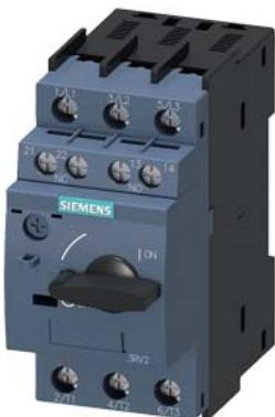
Автоматический выключатель, типоразмер S00 для защиты двигателя, класс срабатывания 10. Максимальный расцепитель тока с обратнозависимой выдержкой времени 0,35–0,5 A. N-расцепитель 6,5 A. Винтовой зажим. Стандартная коммутационная способность с попечечным выключателем вспомогательных цепей 1 НО + 1 НЗ.
