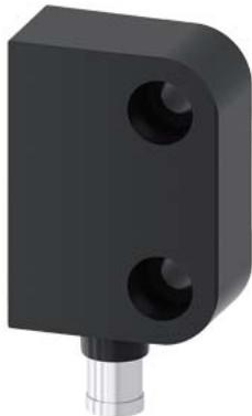
Выключатель с магнитным приводом Контактный блок, прямоугольный малый 26 x 36 мм, для петли двери слева, Контактные элементы: предохранительные контакты 1 НО + 1 НЗ Сигнальный контакт 1 НЗ с соединением с защелкой 8 мм Штекер 6-полюсный, без светодиода подходящий электромагнит 3SE6714-3CA или со смещением 90° 3SE6724-3CA
