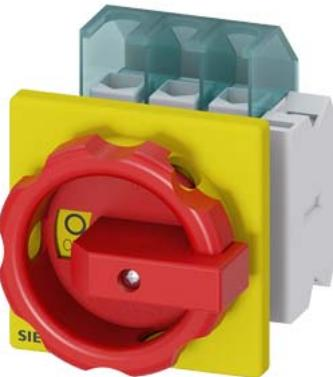
SENTRON, выключатель-разъединитель 3LD, аварийный выключатель, 3- пол., Iu: 32 A, рабочая мощность/ при AC-23A при 400 В: 11,5 кВт, фронтальное крепление, 1 НЗ, 1 НО, поворотный привод, цвет: красный/желтый, 4-винтовое крепление рукоятки
