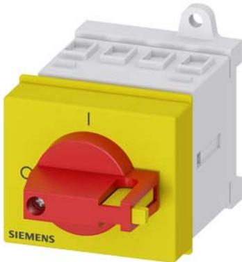
SENTRON, выключатель-разъединитель 3LD, аварийный выключатель, 4- пол., Iu: 16 A, рабочая мощность/ при AC-23A при 400 B: 7,5 кВт, для установки в распред. щиты, привод с поворотной рукояткой, цвет: красный/желтый, рукоятка непосредственно на выключателе
