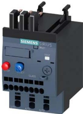
Реле перегрузки 2,8–4,0 А теплов. для защиты двигателя типоразмер S00, класс 10 Для установки на контакторах Главная цепь: пружинная клемма Вспомогательная цепь: пружинная клемма Ручной/автоматический сброс
