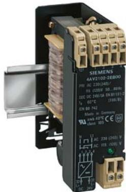
Блок питания; фазы: 1; PN (кВт): 0,024; UPRI (В): 230–115; USEC (В DC): 24; ISEC (А DC): 1/1,2 (60/40 °C); F (Гц): 50–60; группа перекл./экран. эфф.: II 0/0; кл. защиты: I; TA/кл. изол.: 60/B; W (%): 5; IP00; подключение: винтовой зажим/с плоским вставным штекером; монтаж: DIN-рейка; EN 61558-2-6, EN 61131-2 >Изолирующий трансформатор<
