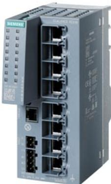
SIPLUS NET, коммутатор SCALANCE XC208, рабочая температура -40 ... +70°C, с конформным покрытием, на основе 6GK5206-2BA00-2AC2 . управляемый IE-коммутатор L2; 8 портов RJ45 10/100 Мбит/с; 1x консольный порт; диагностические LED, резервированное питание, температурный диапазон -40 ... +70°C; Монтаж: стандартная DIN-рейка/профильные шины S7/настенный. Функции резервирования, офисные функции (RSTP, VLAN,...); PROFINET IO Device; совместим с Ethernet/IP, разъём для C-PLUG;
