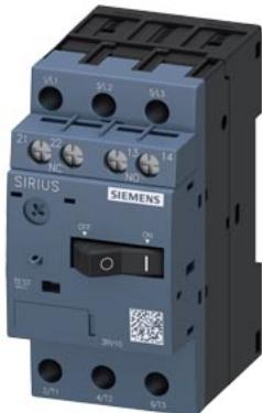
Силовой выключатель, типоразмер S00 для защиты двигателя, класс 10 Максимальный расцепитель тока с обратнозависимой выдержкой времени 0,9–1,25 A N-расцепитель 16 A 1 HO + 1 H3 поперечн. винтовой зажим Стандартная коммутационная способность
