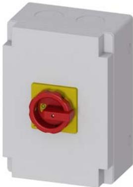
SENTRON, выключатель-разъединитель 3LD, аварийный выключатель, 6- пол., Iu: 63 A, рабочая мощность/ при AC-23A при 400 В: 22 кВт, герметизированный диэлектрический корпус для метрического резьбового крепления, 1 НЗ, 1 НО, поворотный привод, цвет: красный/жёлтый
