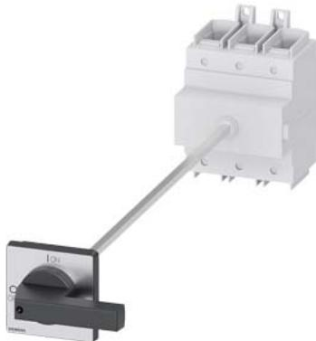
SENTRON, выключатель-разъединитель 3LD, главный выключатель, 3-пол., I<sub>u</sub> = 250 A, рабочая мощности/ при AC-23A при 400 В: 132 кВт, монтаж на горизонтальную поверхность, в т. ч. дверная муфта, привод с поворотной рукояткой, цвет: черный, 4-винтовое крепление рукоятки
