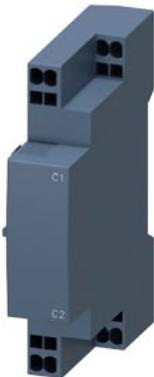
Расцепитель минимального напряжения 230 В AC/50 Гц, 240 В AC/60 Гц с опережающим вспомогательным контактом 2 НО с подключением на пружинных клеммах для автоматического выключателя 3RV2
