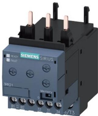
Реле контроля, установка на контактор 3RT2, типоразмер S0 Basic, аналоговая регулировка Мониторинг кажущегося тока 4–40 А, 50–60 Гц, 2-фазн. Питание 24 В AC/DC 1 переключающий контакт Контроль на Превышение и недостижение Выпадение фазы Обрыв провода контроль рампы торможения (с или без датчика) Задержка пуска 0–60 с Отфильтровывание импульсных помех 0–30 с Гистерезис срабатывания 6 % Соединение с помощью винтовых зажимов
