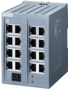
SCALANCE XB116 промышленный неуправляемый коммутатор Industrial Ethernet, 16x электрических RJ45 портов 10/100 Мбит/с; для создания небольших сетей с топологией звезда или шина; светодиодная индикация, IP20, резервированное питание 24В, 24 В AC/DC, электронное руководство доступно для загрузки.
