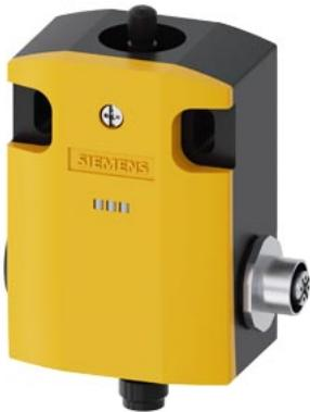
Базовый выключатель без приводной головки металлический корпус, ширина 56 мм ASIsafe встроено Состояние AS-i: 1:F-IN1, 2:F-IN2 3:AS-i/FAULT Контакты зависимого действия 1 Н3 со штекером M12 4-пол. Канал 1 на Н3, канал 2 на гнездовой контакт M12 справа
