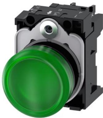
Индикаторная лампа, 22 мм, кругл., пластмасса, цвет: зеленый, линза, гладкая, с держателем, светодиодный модуль, со встроенным светодиодом, 230 В AC, винтовой зажим
