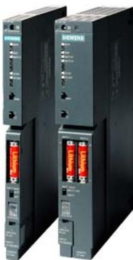
SIMATIC S7-400, блок питания PS405 10 А, широкий диапазон входного напряжения, вход =24/48/60 В; выход =5 В/10 А, для резервированного применения
