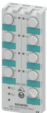
AS-i элемент связи для передачи данных K60, цифровой 4 ЦВх/4 ЦВх, виртуальный, IP67 Модуль занимает 2 адреса Монтажная панель 3RK1901-0CA00 заказывается отдельно
