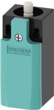
Позиционный выключатель Пластмассовый корпус согласно DIN EN 50047, 31 мм Подключение устройства 1 x (M20 x 1,5) 1 HO/1 H3, контакты мгновенного действия (возможность замены) Закругленный толкатель, форма В с тефлоновым толкателем
