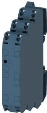
Разделительный преобразователь 24–240 В AC/DC, 3-канальное разделение Вход: 0–10 В, 0/4–20 мА; выход: 0–50/100 Гц/1/10 кГц; пружинная клемма (Push-In)
