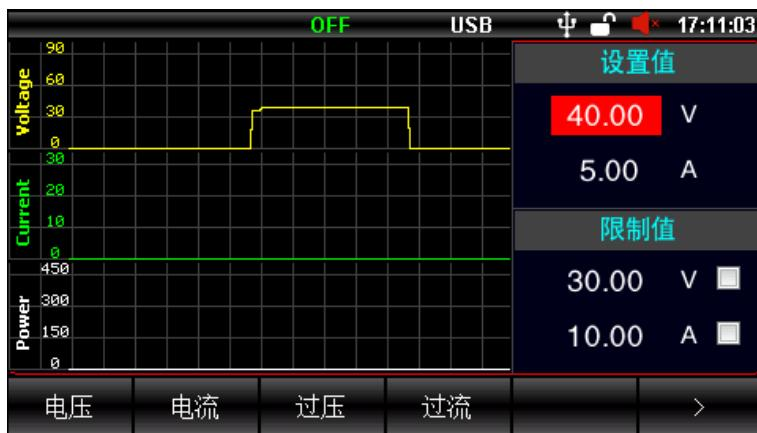
可以显示电压电流功率的波形，当设置或者输出变动时，能够非常直观的显示出来。
