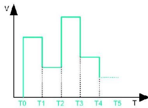
列表模式提供最多 200 步的序列输出，每一步都可以自定义电压电流和输出时间，以适应各种输出需求，输出结束后可以列表循环也可以终止循环。
