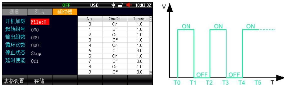
延时器模式提供最多 200 步的序列输出，和列表模式相比，只有输出和不输出两种状态，输出参数就当前设置参数，简化了用户设置。
