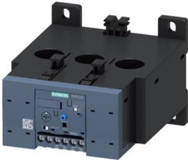
Реле перегрузки 50–200 А для защиты двигателя Типоразмер S6, класс 1 НЗ Для установки на контакторах/автономной установки Главная цепь: шинный трансформатор тока. Вспомогательная цепь: винтовое соед. Ручной/автоматический сброс
