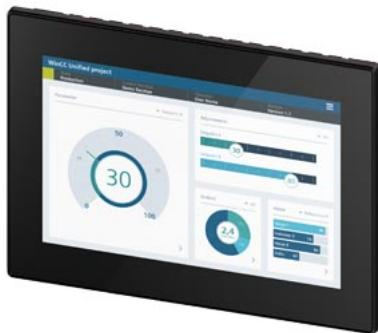
SIMATIC HMI, панель MTP1200 серии Unified Comfort, без логотипа Siemens, сенсорное управление, широкоформатный TFT-дисплей с диагональю 12.1", 16 млн цветов, интерфейс PROFINET, настройка в среде разработки WinCC Unified Comfort V16, содержит ПО с открыты
