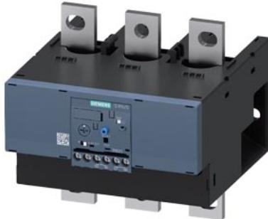
Реле перегрузки 160–630 А для защиты двигателя Типоразмер S10/S12, класс 1 Н3 Для установки на контакторах/автономной установки Главная цепь: шинное соед. Вспомогательная цепь: винтовое соед. Ручной/автоматический сброс
