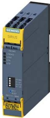
Предохранительное устройство SIRIUS Базовое устройство, стандартная серия Электронные разблокирующие цепи 2 разблокирующие цепи плюс 1 сигнальная цепь  $U_s = 24$  В DC Винтовой зажим
