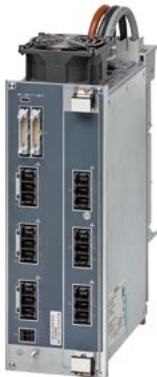
SIPLUS HCS4300, модуль POM4320 Highend для шинного монтажа (IEC). Силовой выходной модуль для монтажа на шину. С 6 выходами каждый макс. 15360 Вт (для режима работы полуволнового управления: в зависимости от пускового тока ограничения нагрузки до макс. 6400 Вт)
