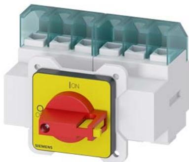
SENTRON, выключатель-разъединитель 3LD, аварийный выключатель, 6- пол., Iu: 25 A, рабочая мощность/ при AC-23A при 400 В: 9,5 кВт, фронтальное крепление, , привод с поворотной рукояткой, цвет: красный/желтый, 4-винтовое крепление рукоятки, нулевое положение - запираем.
