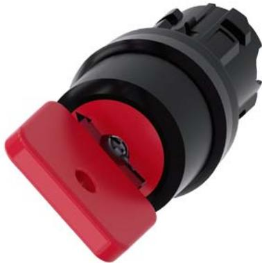
Переключатель с ключом О.М.Р, 22 мм, кругл., пластмасса, номер замка 73037, цвет: красный, с 2 ключами, 2 положения переключателя О-И, с фиксацией, угол переключения 90°, 10:30 ч/13:30 ч, извлечение ключа О
