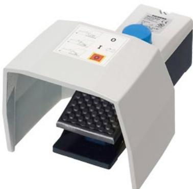
Безопасный ножной выключатель 1-педальный, с защитным кожухом, IP65, с функцией блокировки, 2 НО + 2 НЗ, Замыкающий контакт, замыкает как кнопочный выключатель, Размыкающий контакт, размыкает с одновременной фиксацией (функция безопасности) Ввод проводов M20 x 1,5
