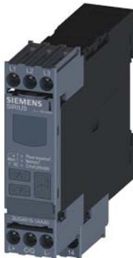
Цифровое реле контроля для 3-фазного напряжения питания для IO-Link AC, 50–60 Гц 3 x 160–690 В Чередование фаз, Выпадение фазы Асимметрия фаз пониженное и повышенное напряжение Гистерезис 1–20 В Время стабилизации сети Время задержки срабатывания 1 переключающий контакт, винтовой зажим
